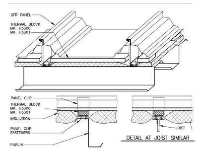
THERMAL BLOCK DETAIL AT TALL / SUPER CFR CLIPS
